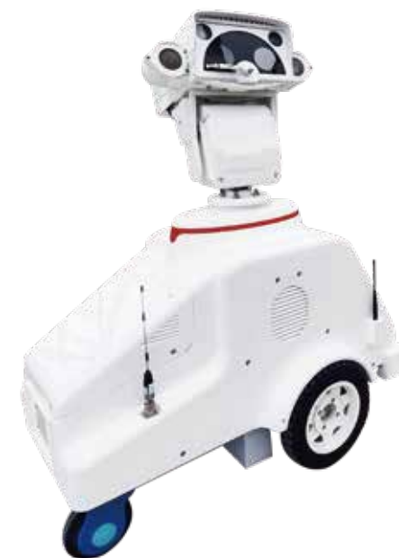
智能巡检机器人
